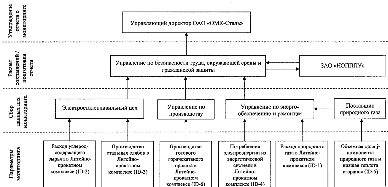
Рис. Б.2-1. Принципиальная схема сбора, передачи и обработки данных мониторинга
